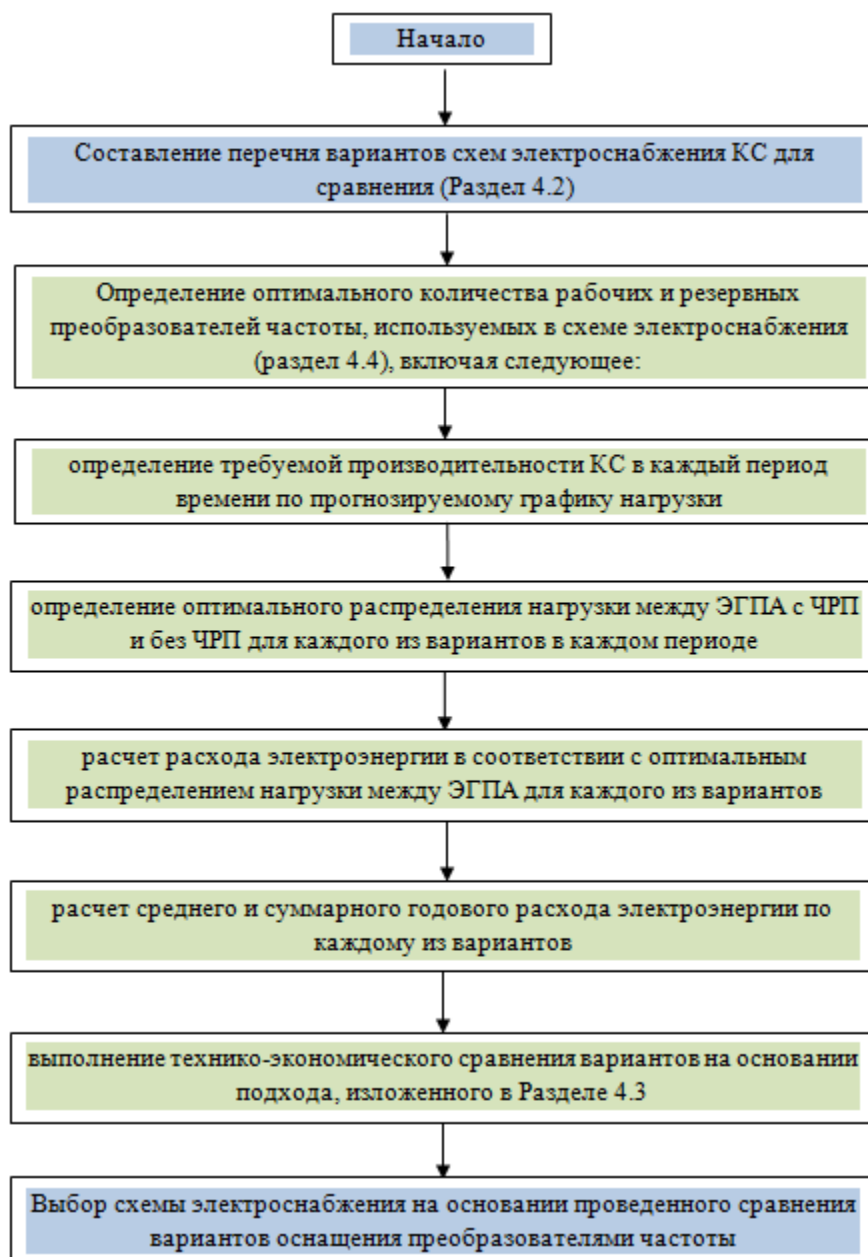
Рисунок 4.2 - Алгоритм выбора оптимальной схемы электроснабжения ЭГПА на КС
